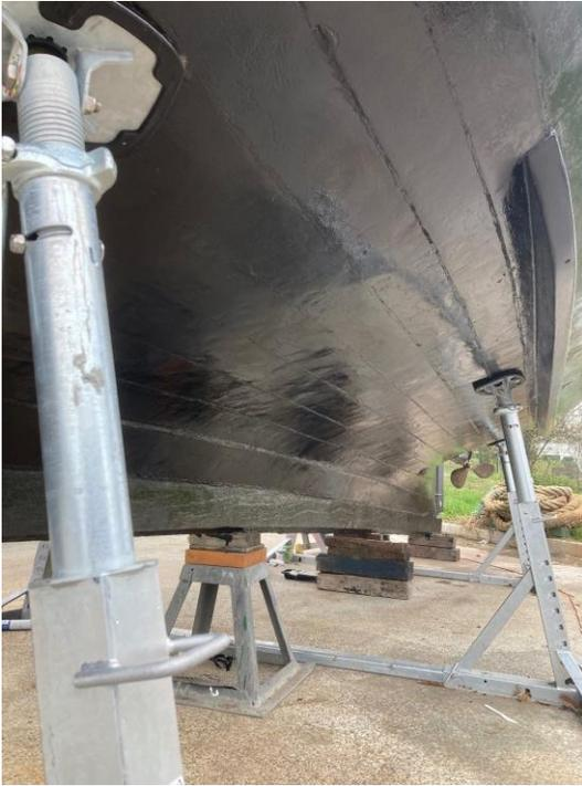
Sa coque totalement restaurée et recalfatée est à bordés à franc-bord en acajou (3 cm d'épaisseur) fixés sur de solides membrures en chêne. Les clous aciers ont été déposés et remplacés. Protection partie immergée par Blacktune.
