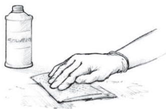
Figure 6 Nettoyez la surface. Utilisez un solvant, si nécessaire, pour enlever tout ce qui est contaminé.
